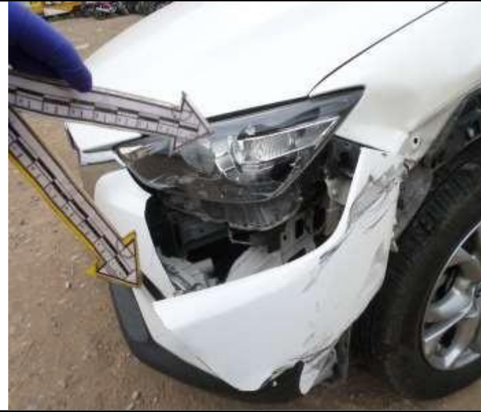
IMG. – 8748. Primer plano, parte lateral izquierdo, bómper averiado por rotura, luna farola averiada por rotura desprendimiento parcial, luna farola averiada por rotura, del vehículo de placas AAA-123.
