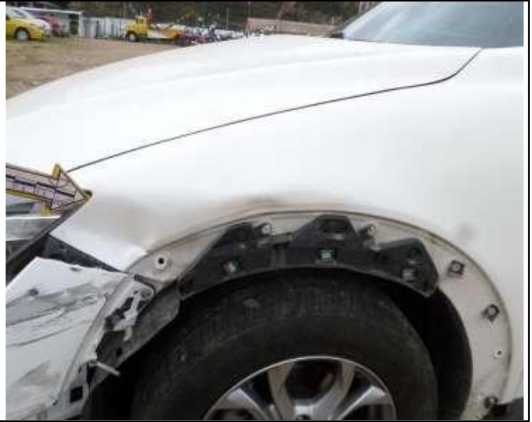
IMG. – 8750. Primer plano parte lateral anterior superior izquierdo, guardafango averiado por abolladura, del vehículo de placas AAA-123.
